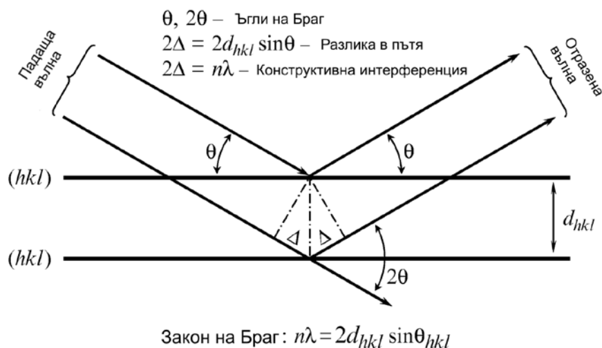
Фиг. 2. Геометрично представяне на закона на Браг за две успоредни равнини от атоми
